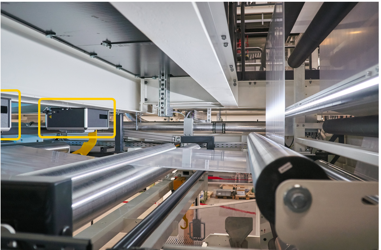
Folieninspektionssystem in einer Blasfolienanlage: Die Bildverarbeitungssysteme (im Bild markiert) detektieren Oberflächenfehler wie Stippen, Black Specks, Fischaugen, Beschichtungsaufrisse, Schlieren, Fließlinien oder Insekten. © OCS
